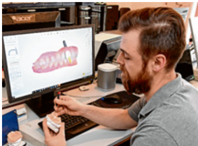
Florian Rießenberger arbeitet mit digitalem Zahnabdruck und Modell aus dem 3-D-Drucker.
