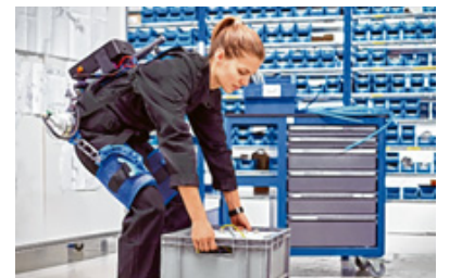
Das Exoskelett im Einsatz: Es entlastet den Rücken. Foto: German Bionic System
