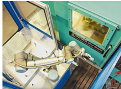
Bei Maschinenbau Anton Fries erledigt ein Roboter das monotone Einlegen in die Drehmaschine.
